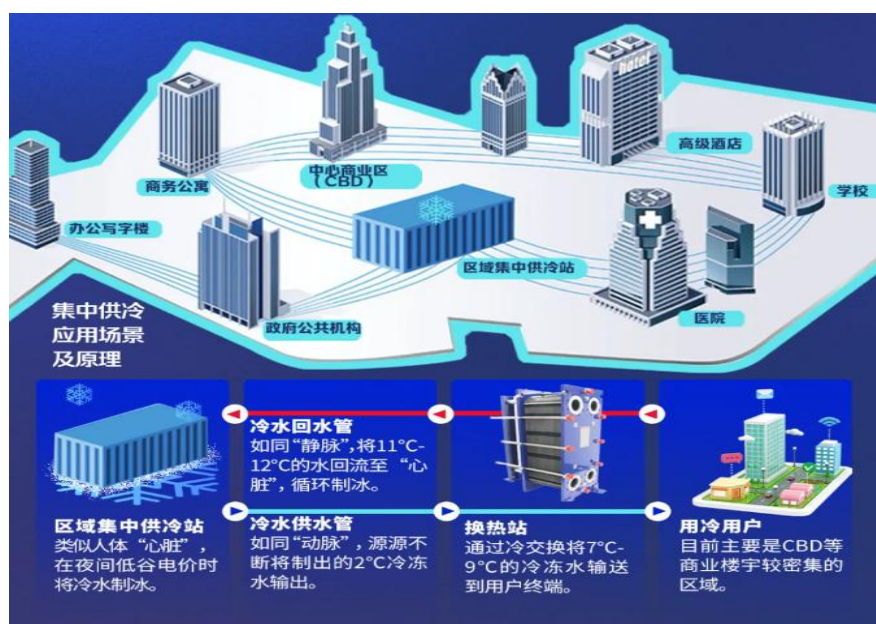
图5-4 蓄能型集中供冷工程示意图
